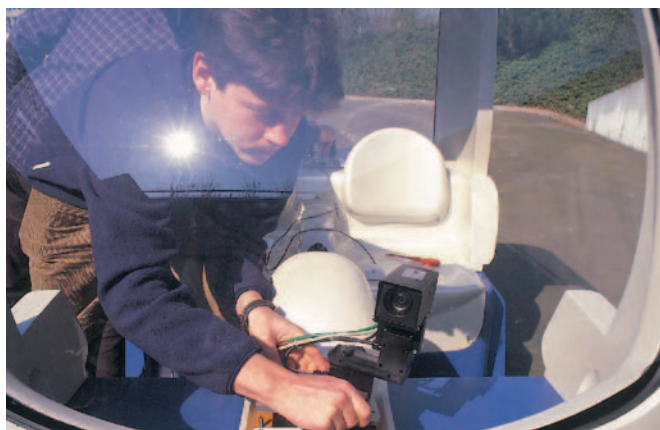
Montage du kit d'alimentation de la caméra embarquée sur un Cycab (véhicule électrique deux places).
